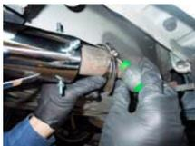
カッターを最適な位置に4点の取付ボルトを締めて固定
